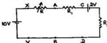
දී ඇති පරිපථයේ R විචලන ප්‍රතිරෝධයක් වන අතර කෝෂ දෙකෙහි අභ්‍යන්තර ප්‍රතිරෝධ ගොනවල සොයා ගිය හැකි තරම් කුඩා ය.  $R$  හි අගය 50  $\Omega$  වූ විට AB අතර සම්බන්ධ කරන ලද වෝල්ට් මීටරයක පාඨාංකය 5 V වේ.  $R = 50 \Omega$  හි තබා ගනිමින් 10 V කෝෂය ඉවත් කර XY අග්‍ර එකිනෙකට සම්බන්ධ කළ හොත් CD හරහා සම්බන්ධ කර ඇති වෝල්ට් මීටරයක පාඨාංකය 1.5 V වේ.  $R_1$  සහ  $R_2$  ගණනය කරන්න.
